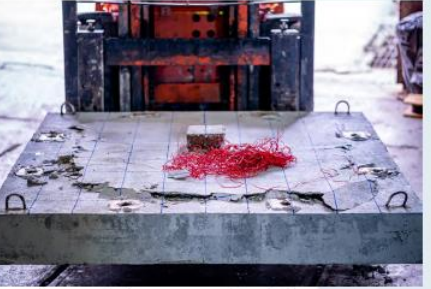
รูปที่ 7 ลักษณะการรับน้ำหนักของตัวอย่างทดสอบ สะท้อนการรับน้ำหนักในรูปแบบการเฉือน
