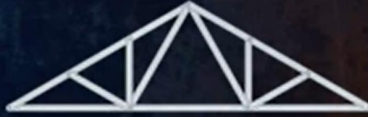
Fan roof truss
