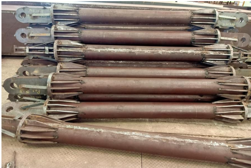
Fabrication : Fit up Strut pipe
