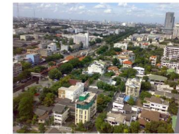
รูปที่ 0.2.5 ตัวอย่างสภาพภูมิประเทศแบบ B ซึ่งเป็นสภาพภูมิประเทศแบบชานเมืองหรือพื้นที่ที่มีต้นไม้ใหญ่อยู่หนาแน่น หรือเป็นบริเวณศูนย์กลางเมืองขนาดเล็ก
