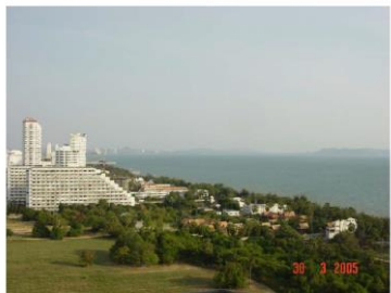
รูปที่ ๑.2.4 ตัวอย่างสภาพภูมิประเทศแบบ A ซึ่งเป็นสภาพภูมิประเทศขังโดยสิ่งกีดขวาง พื้นไม้หรือสิ่งปลูกสร้าง กระจัดกระจายอยู่ห่างๆ กัน หรือเป็นบริเวณชายฝั่งทะเล
