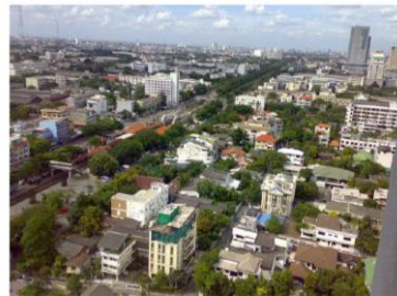
รูปที่ ๑.2.5 ตัวอย่างสภาพภูมิประเทศแบบ B ซึ่งเป็นสภาพภูมิประเทศแบบชานเมือง หรือพื้นที่ที่มีต้นไม้ใหญ่จำนวนมาก หรือบริเวณศูนย์กลางเมืองขนาดเล็ก
